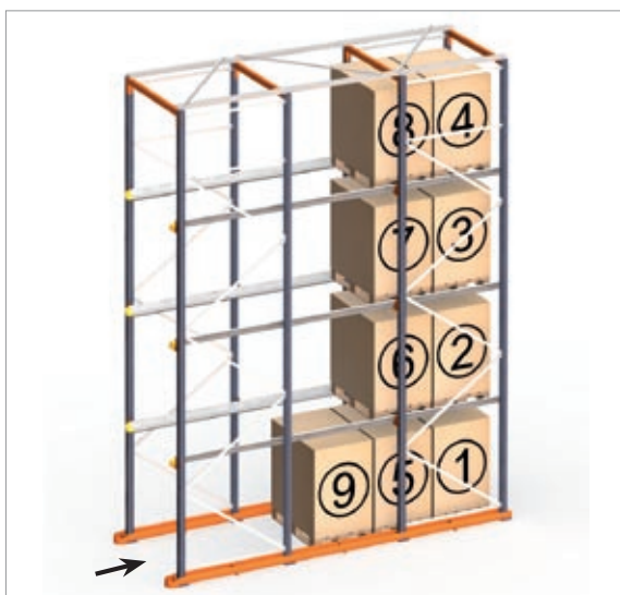
Séquence d'entrée de charge.
