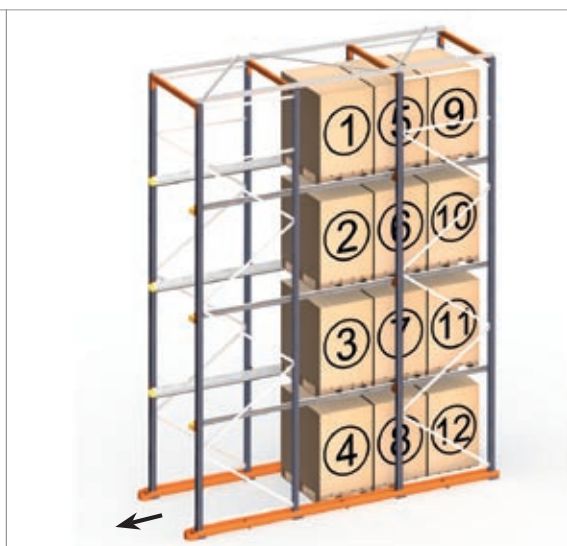
Séquence de retrait de charge.
