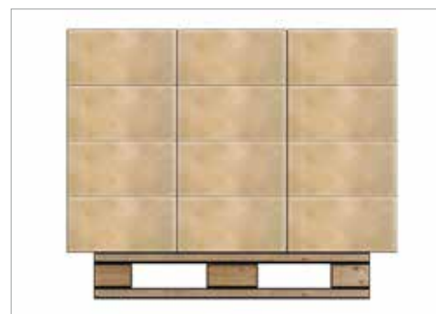
Dimensions plus importantes que celles de la palette mais charge centrée sur cette dernière.
