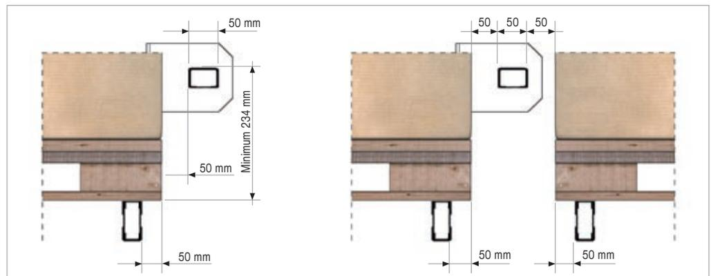
Rayonnage simple et double avec profil de sécurité.
