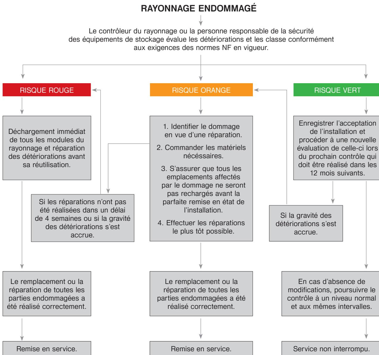
Procédure de contrôle pour le classement des détériorations.
