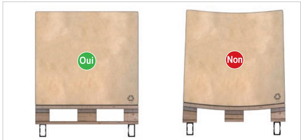
Une concentration de charge dans la zone centrale des lisses est à éviter, soit en rapprochant les palettes soit en changeant l'unité de charge.
