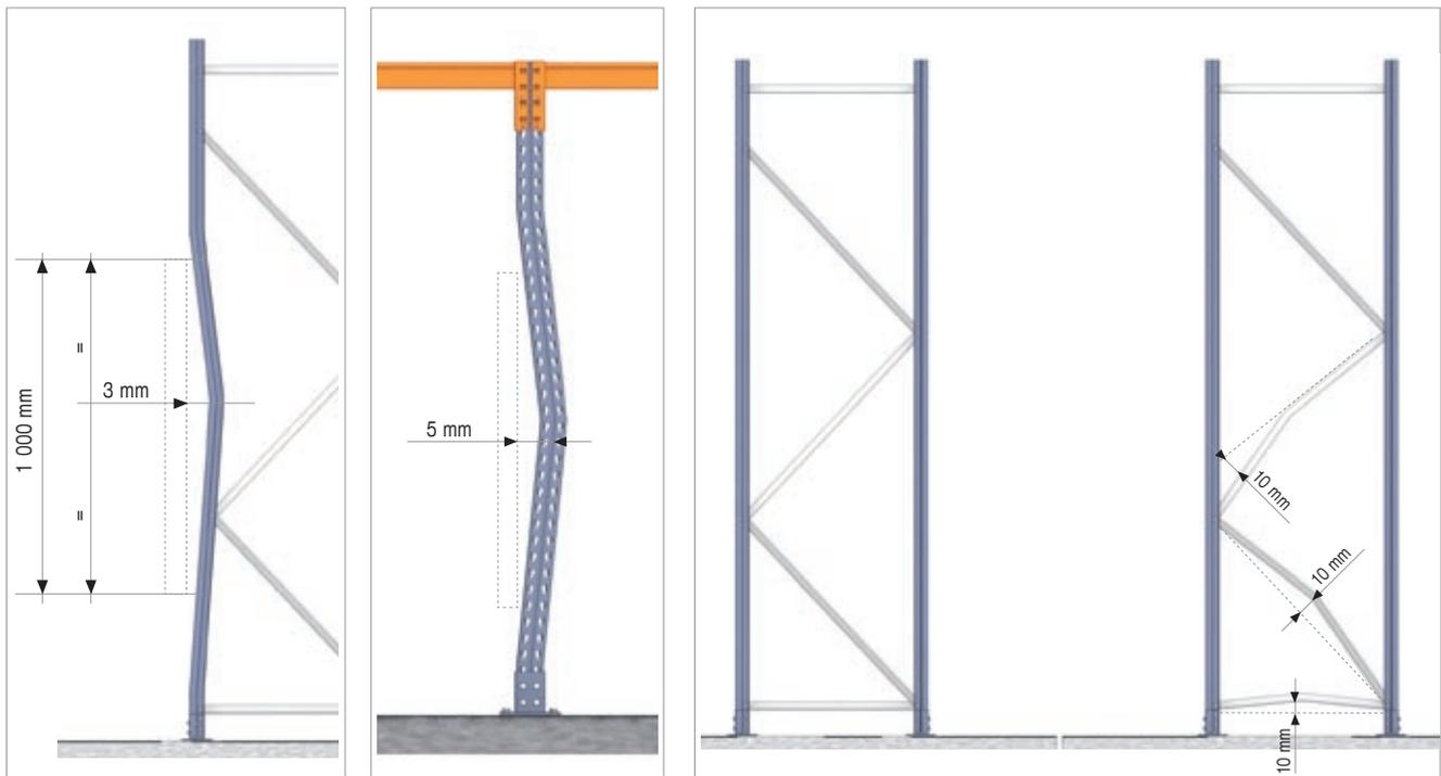
**A)** Montants pliés dans le sens du plan de l'échelle. Déformation permanente supérieure ou égale à 3 mm mesurée au centre d'un intervalle de 1 m de long.
