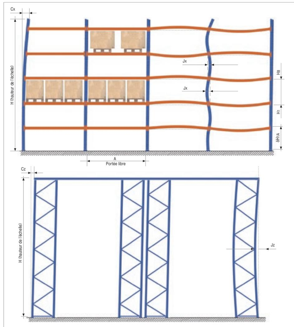
Les dimensions maximales admissibles après le montage ne doivent pas dépasser les valeurs suivantes :
