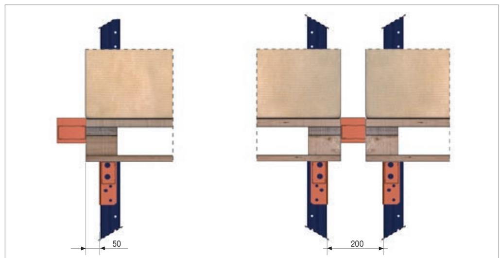
Rayonnage simple et double avec profil de positionnement.
