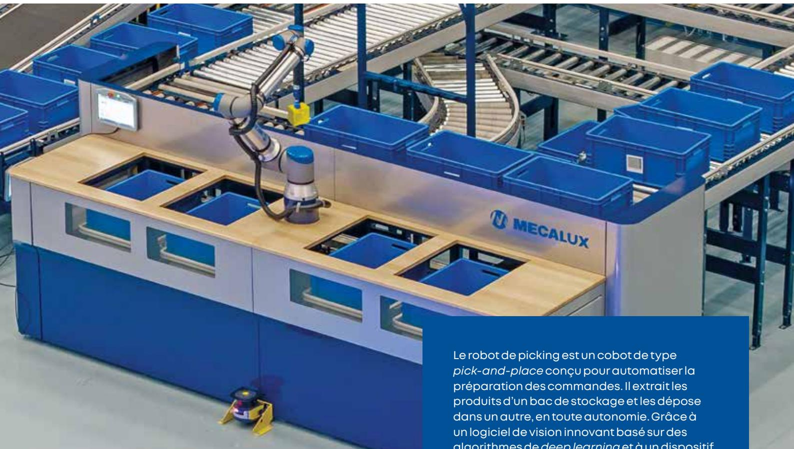
Le robot de picking est un cobot de type *pick-and-place* conçu pour automatiser la préparation des commandes. Il extrait les produits d'un bac de stockage et les dépose dans un autre, en toute autonomie. Grâce à un logiciel de vision innovant basé sur des algorithmes de *deep learning* et à un dispositif de préhension polyvalent, le robot manipule avec une précision absolue une grande diversité d'articles aux formes, surfaces et dimensions variées.
