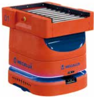
AMR 100 Box avec convoyeur à chargement par l'avant d'un bac de 400 mm de large.
