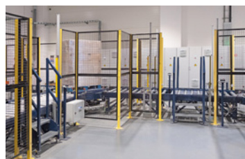
Convoyeurs à palettes automatiques. Ils ont permis de réduire le nombre de chariots élévateurs.
