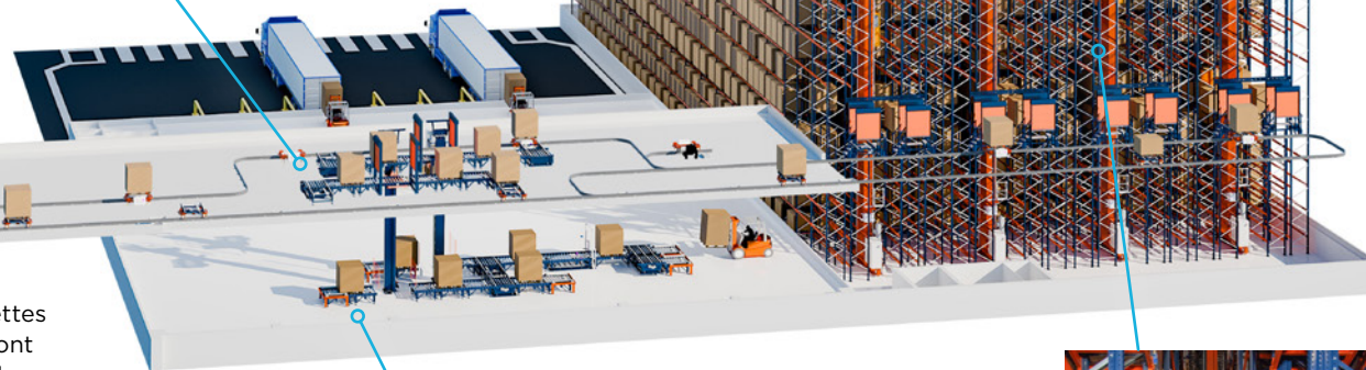
Quatre transstockeurs à fourches télescopiques effectuent jusqu'à 130 cycles combinés par heure , garantissant ainsi des entrées et des sorties ininterrompues.
