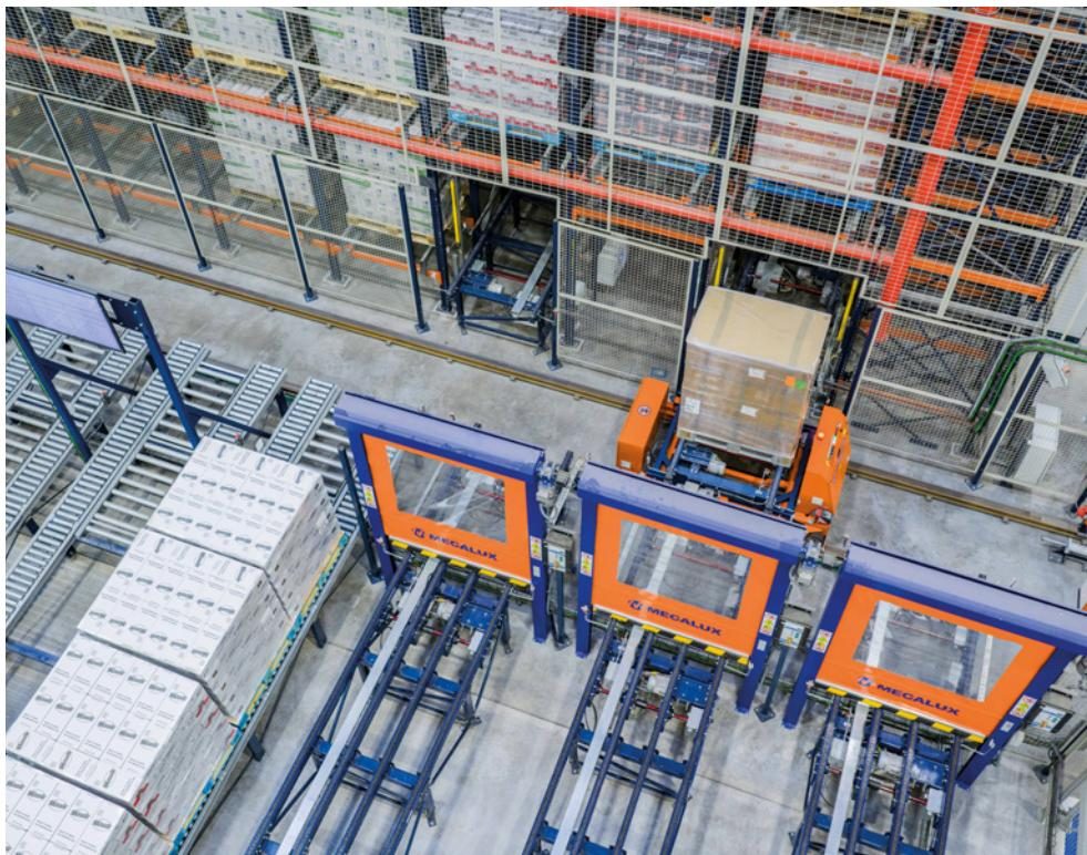
sur le côté du bâtiment. Un ensemble d'AGV transfère ensuite les marchandises vers les convoyeurs de palettes, qui les placent finalement dans le système Pallet Shuttle automatique avec transtockeur. Grâce à la coordination entre ces équipements, des flux 100 % automatisés sont possibles sans intervention manuelle.
