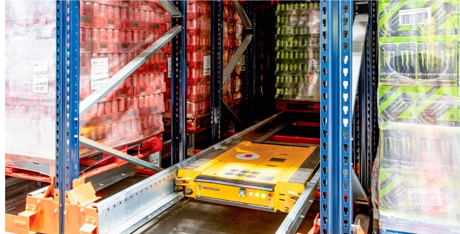
La filiale irlandaise vient d'ouvrir un nouvel entrepôt de produits finis à Knockmore Hill, Lisburn en Irlande du Nord, équipé du système Pallet Shuttle semi-automatique de Mecalux, dans le but d'adapter son infrastructure logistique à la demande croissante. Cette solution allie une haute densité de stockage, un accès direct aux palettes et un contrôle strict des stocks, garantissant la distribution des boissons en temps voulu.
