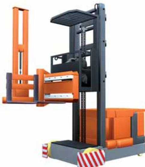
Les chariots préparateurs de commandes, de même que ceux à mât inclinable rétractable, doivent être guidés à l'intérieur des allées de stockage.
