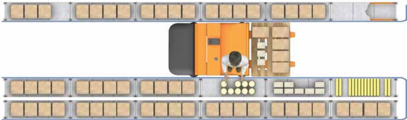
Chaque modèle de machine nécessite un type de rail-guide approprié et une largeur d'allée différente. La largeur de l'allée est définie par la distance entre les rails-guides et la distance entre les niveaux de charge.
