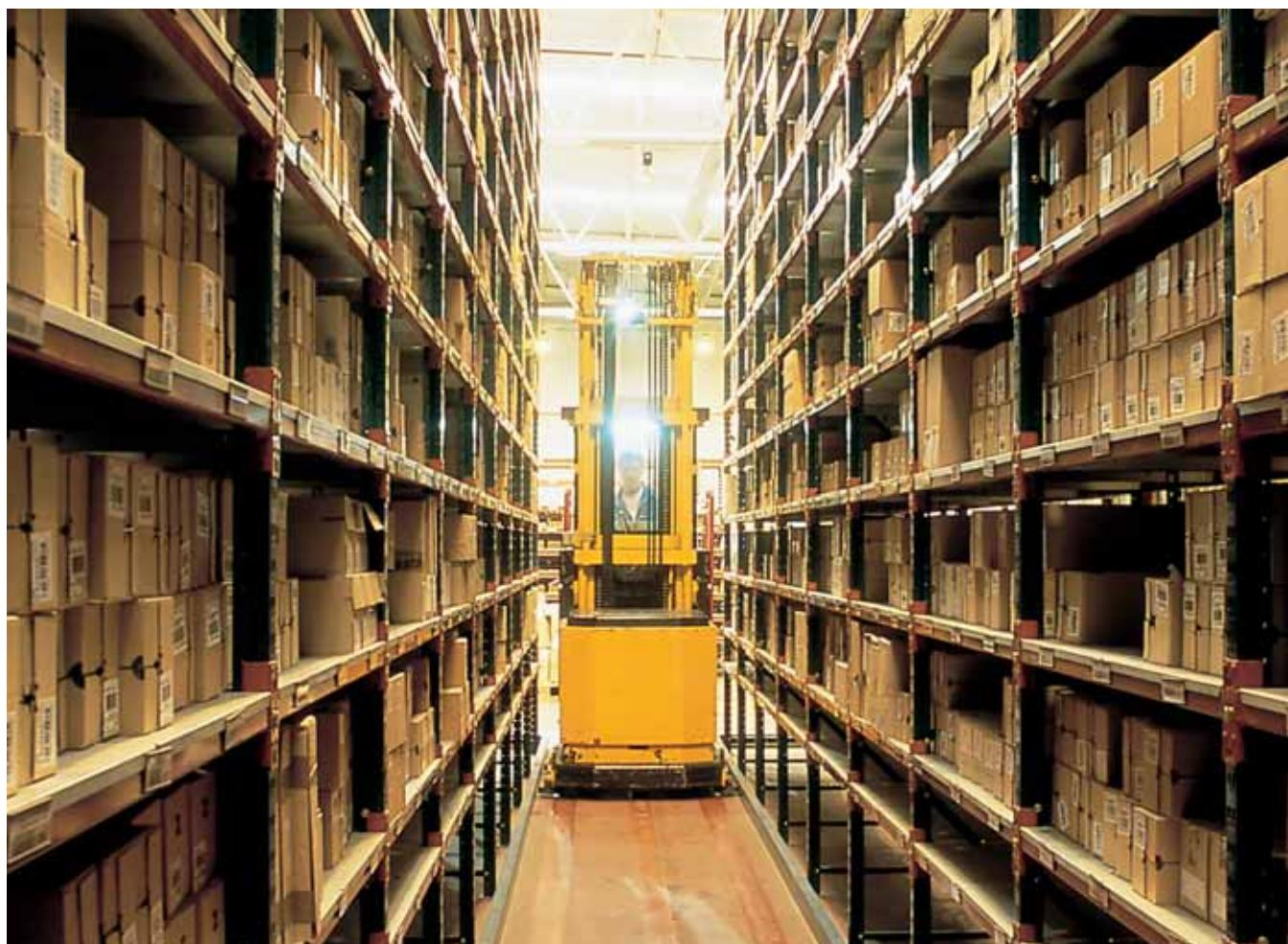
Il existe deux familles de machines, celles qui ne permettent de travailler que sur les niveaux les plus bas (préparateurs de commandes faible hauteur) et celles qui peuvent éléver l'opérateur jusqu'aux niveaux les plus hauts des rayonnages (préparateurs de commandes en hauteur).
