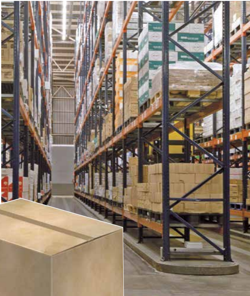
Afbeelding boven. Palletstelling waarbij pallets aan de zijde van 1200 mm worden geladen en gelost
