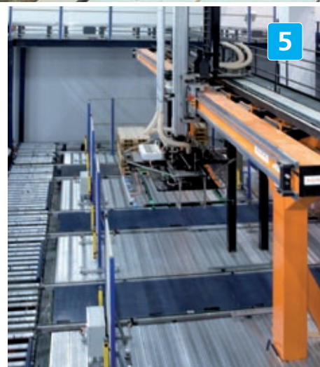
Le robot de picking automatique permet de préparer les commandes des produits à forte rotation par couches. Les palettes sont alimentées au moyen des transstockeurs et des convoyeurs de la chambre automatique.
