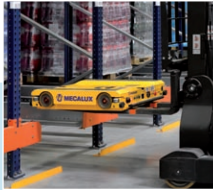
Stockage par accumulation à Pallet Shuttle
