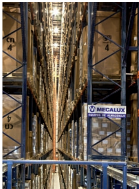
Allée de stockage équipée d'un transstockeur.
