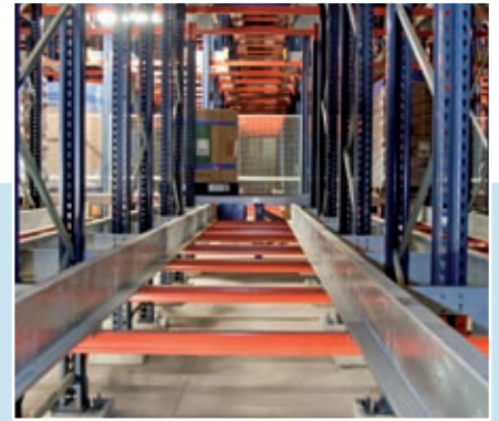
Stockage par accumulation à chariot satellite
