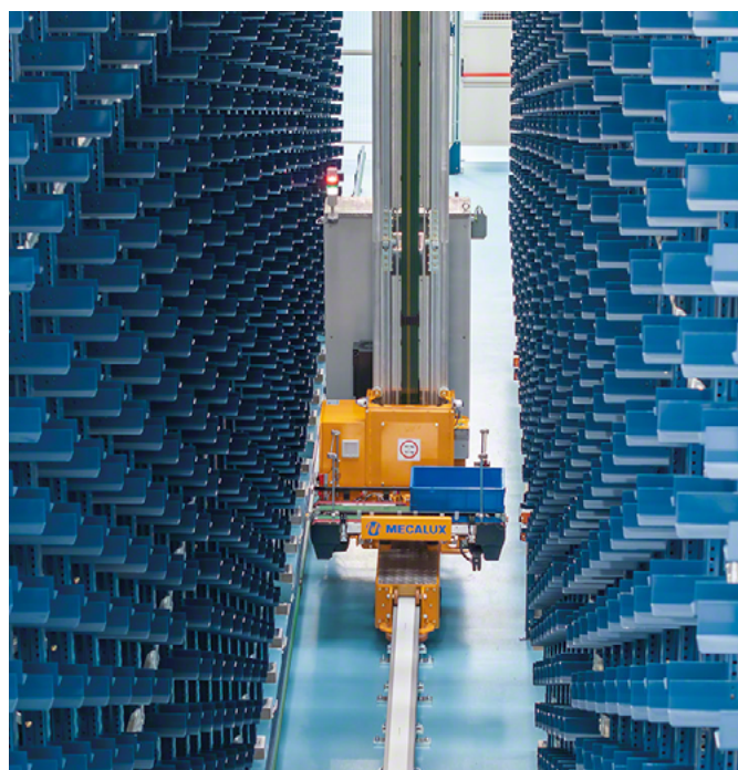
MLB100Q-stapelkraan met dubbele mast Bereikt hoogtes tot 20 m en verwerkt twee laadeenheden van 100 kg of vier van 50 kg.
