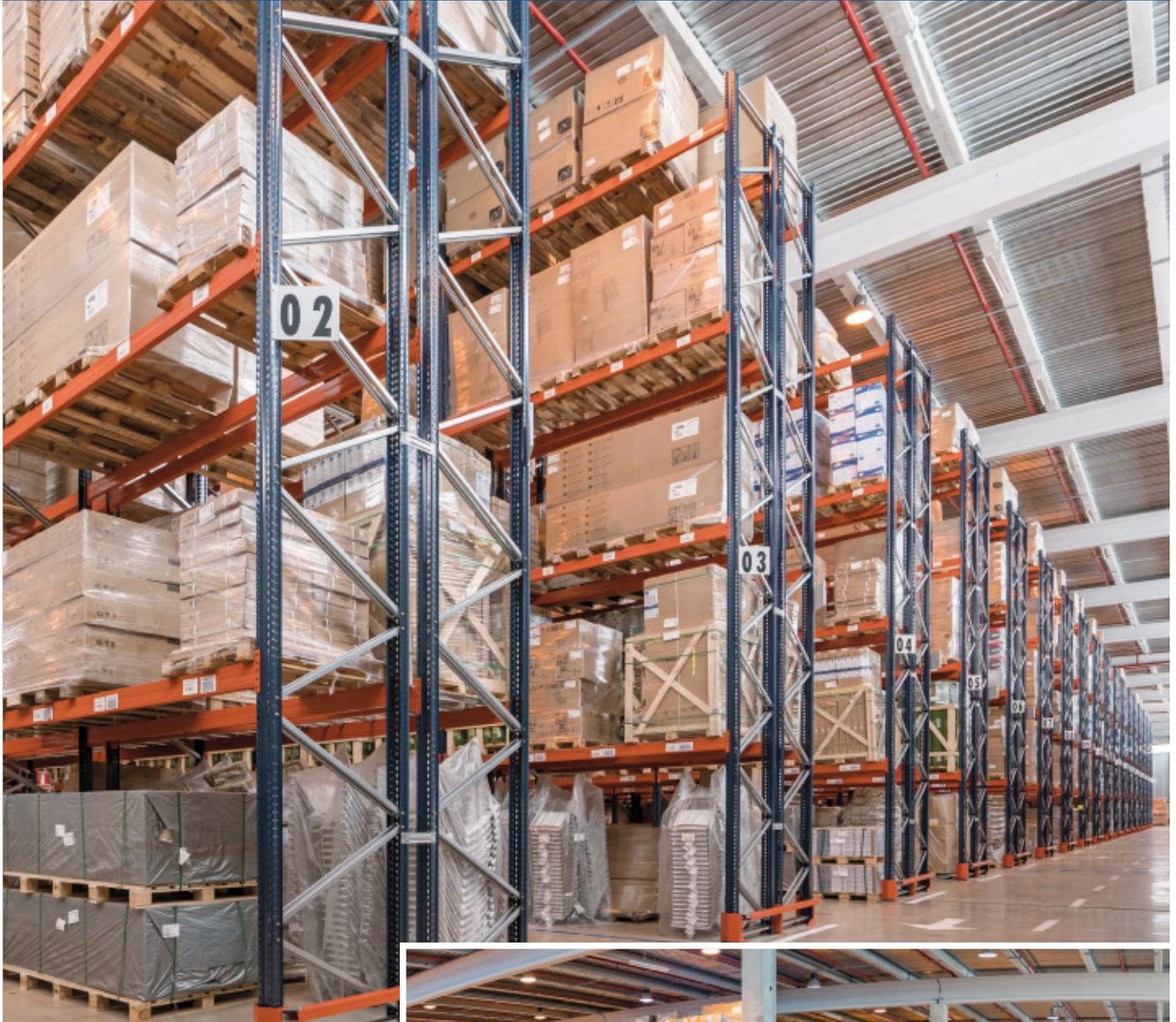
Les deux nouveaux entrepôts que Leroy Merlin a construits à Torija (Espagne) sont équipés de rayonnages à palettes Mecalux. Leur capacité totale de stockage est de plus de 21 600 palettes. Cette solution se distingue par sa polyvalence pour le stockage des palettes de différents volumes et dimensions. De plus, elle permet d'accélérer les tâches liées au stockage.
