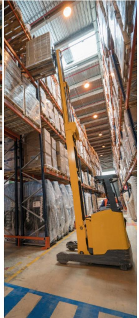
Les opérateurs travaillent par zones et se voient assigner des allées déterminées. Les opérateurs y utilisent des chariots à mât rétractables pour introduire et retirer les palettes provenant de l'extérieur sont déposées sur l'un des côtés, en attendant d'être placées dans les emplacements qui leur sont assignés. Une zone de préchargement a été aménagée sur le sol, face aux quais, pour y accumuler la marchandise consolidée.
