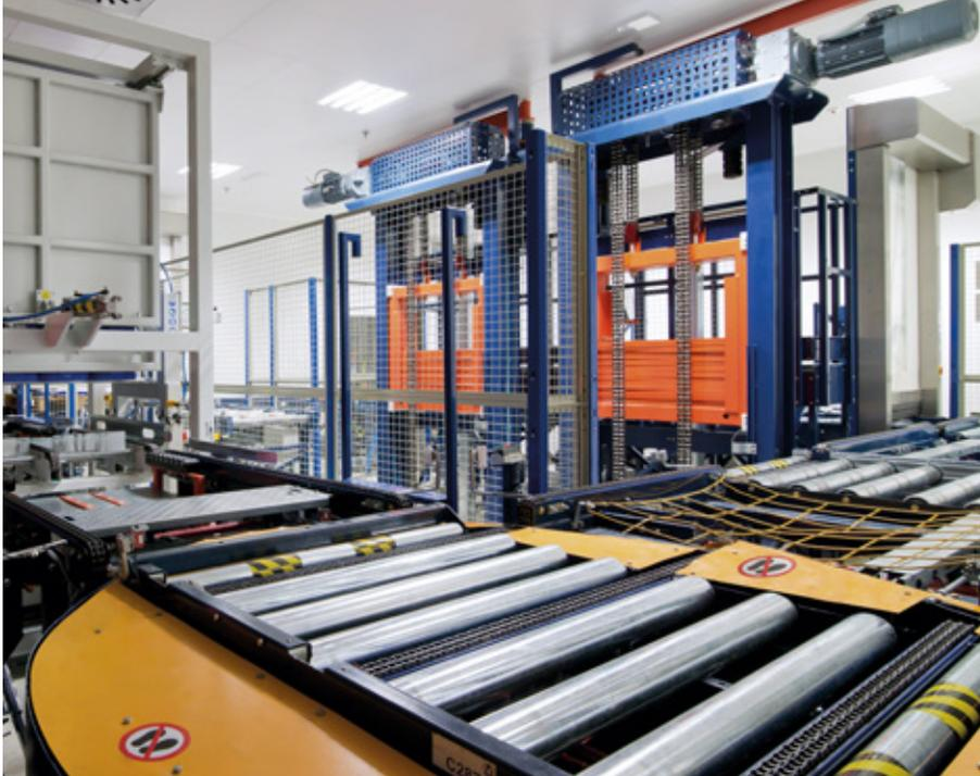
Les deux niveaux communiquent entre eux par l'intermédiaire de deux élévateurs. L'un d'eux approvisionne la zone de conditionnement en bouteilles et l'autre en caisses carton.
