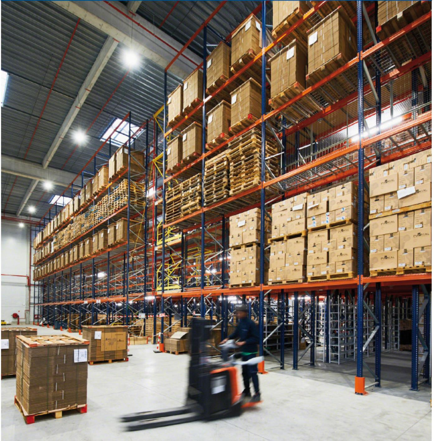
Mecalux a équipé l'un des entrepôts du centre documentaire qu'Everial possède à Lyon (France) de rayonnages avec passerelles. Ces derniers offrent sur cinq niveaux, une capacité totale de stockage de 360 000 caisses. Il s'agit d'un système de stockage simple qui se distingue des autres car il exploite toute la surface, et permet d'accélérer grandement la recherche et la manutention des dossiers.
