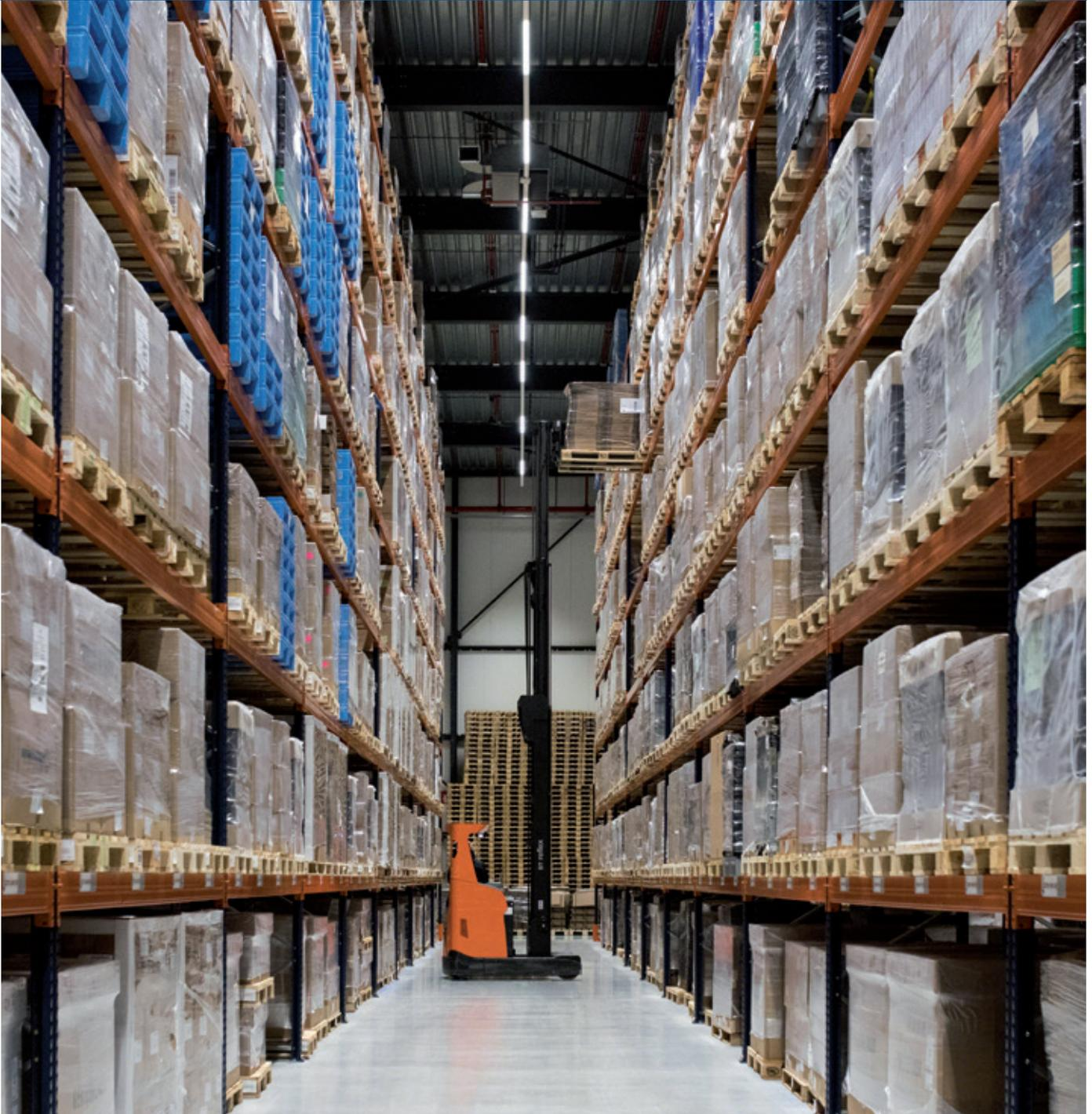
L'opérateur logistique Van Rooijen a équipé son nouvel entrepôt situé à Turnhout (Belgique) avec des rayonnages à palette de Mecalux ayant une capacité de stockage totale de 32 500 palettes. En plus d'optimiser la capacité de stockage pour entreposer tous les produits de ses clients, ce système permet l'accès direct à la marchandise, ce qui accélère les tâches de stockage et de préparation de commandes.
