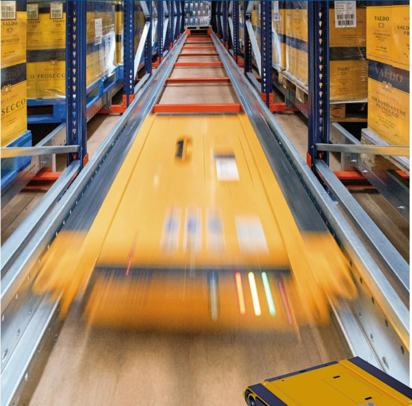
L'opérateur logistique Logistic Net a équipé son entrepôt de Bassano del Grappa (Italie) de rayonnages par accumulation, approvisionnés par quatre navettes Pallet Shuttle de Mecalux, chargées de transporter la marchandise à l'intérieur des canaux de stockage. Grâce à cette solution, l'entreprise spécialisée dans la logistique tierce partie peut stocker plus de 3 000 palettes et les contrôler au moyen d'une tablette de commande.
