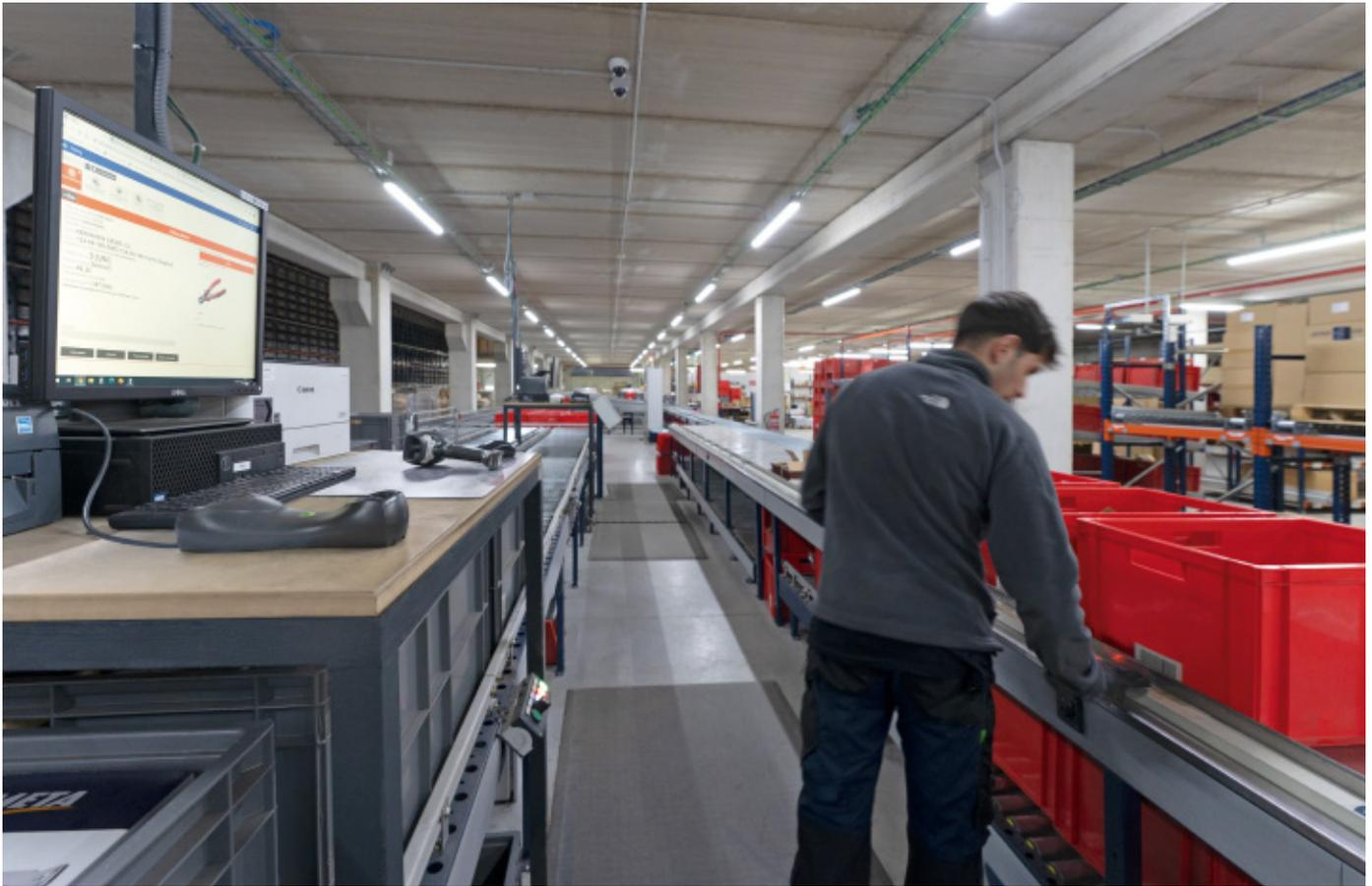
mandés aux extrémités des rayonnages des entrepôts automatisés pour accélérer leur entrée et leur sortie. Pour les palettes devant être fractionnées, une zone de travail a été aménagée où les marchandises sont placées dans des bacs. Ces derniers sont ensuite déposés sur le convoyeur menant au magasin automatique pour bacs. Pour plus de rapidité et éviter les erreurs, les opérateurs suivent les instructions données par EasyWMS.
