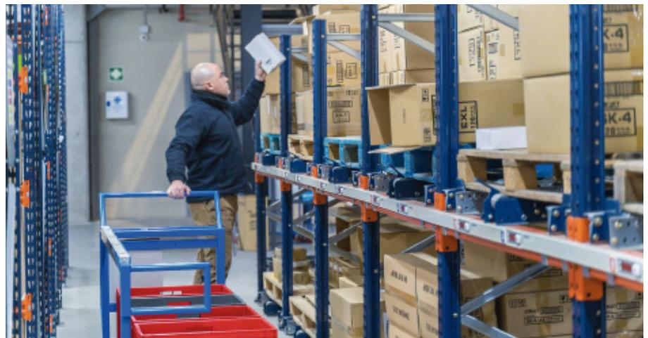
**Poste de picking associé au magasin automatique pour palettes.** Situé à l'avant, il permet de préparer jusqu'à sept commandes simultanément.
