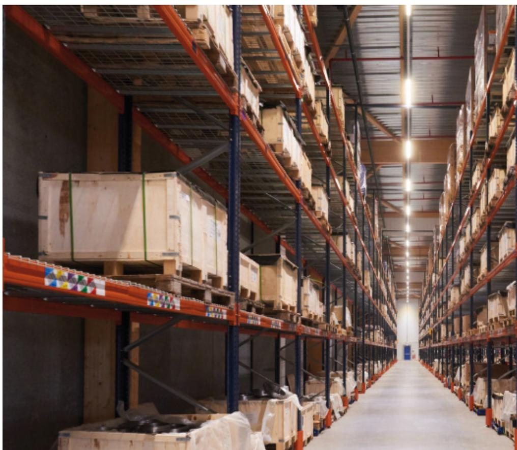
Les rayonnages à palettes de Sofinther offrent une capacité de stockage de 12 000 palettes de 800 x 1 200 mm d'un poids maximal de 1 000 kg
