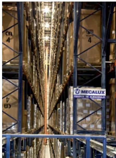
Allée de stockage équipée d'un transstockeur.
