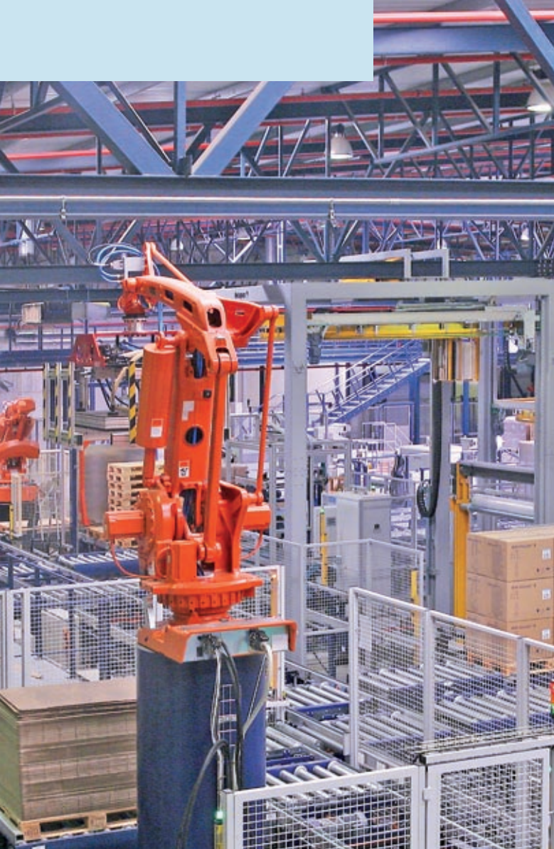
Schéma de fonctionnement du système de picking automatique par robot dépalettiseur.
