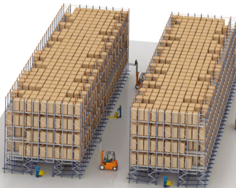
Oplossing 4. Magazijn met twee stellingmodules en toegang aan beide zijden en een orderpicking area op de laagste niveaus
