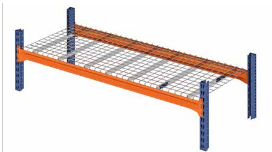
Détail de l'étagère grillagée.
