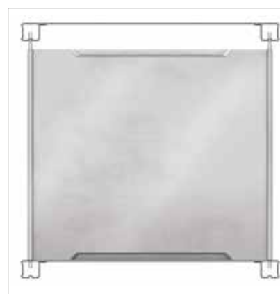
Détail de fixation sur panneau supérieur et inférieur.
