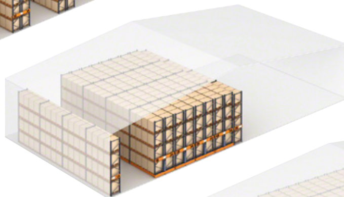
Rayonnage sur bases mobiles. Il possède la même capacité de stockage que le rayonnage ci-dessus, mais, desservi par une seule allée, il occupe moins d'espace.
