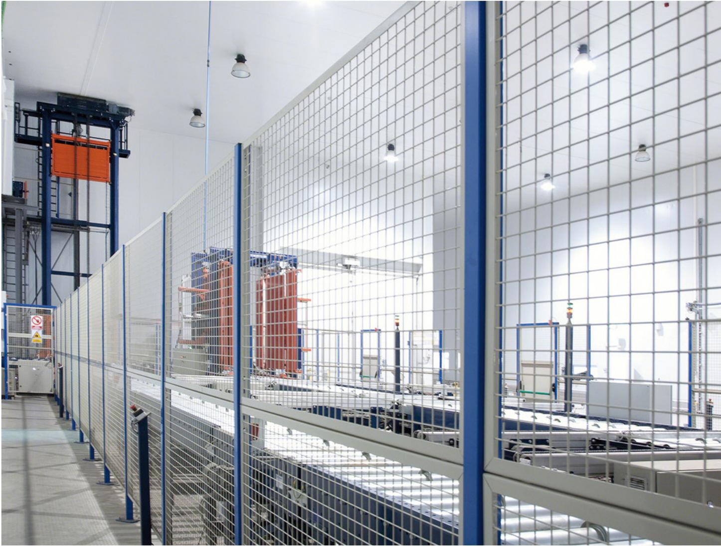
**Les cloisons industrielles grillagées de sécurité créent un espace protégé dans la zone de travail des installations automatiques et des robots de fabrication.**
