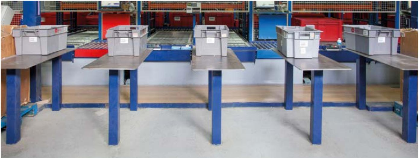
Le convoyeur du magasin automatique d'Unidroco est doté de quatre postes de picking équipés de dispositifs 'put-to-light'
