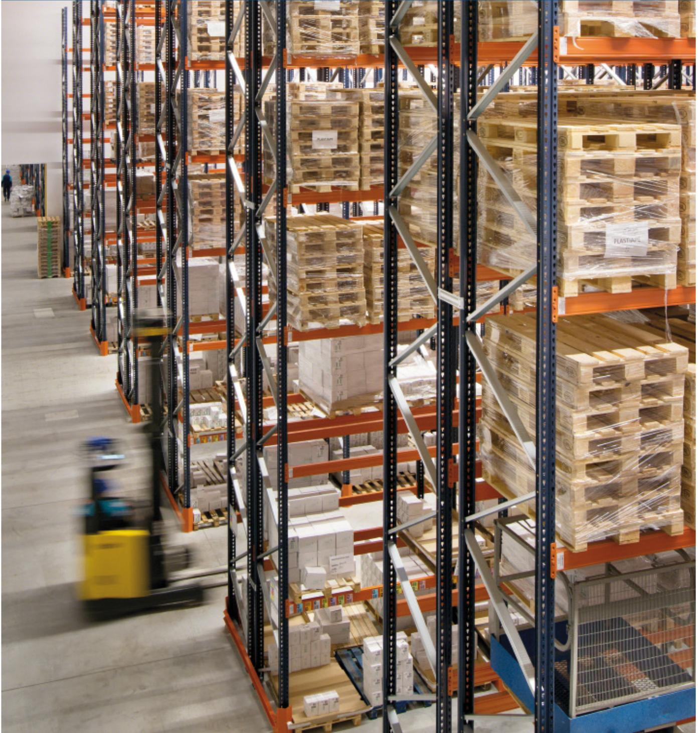
Le nouvel entrepôt de Ziaja, fabricant polonais de cosmétiques et de produits pharmaceutiques naturels, a été spécialement conçu pour faciliter la principale opération de ce centre : le picking. Mecalux l'a équipé de rayonnages à palettes, qui offrent un accès direct à la marchandise et une capacité de stockage de 10 906 palettes.
